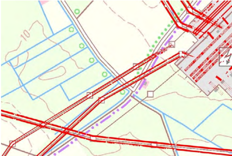
Abb. 15: Hochspannungsleitungen aus den Laserscandaten in rot
