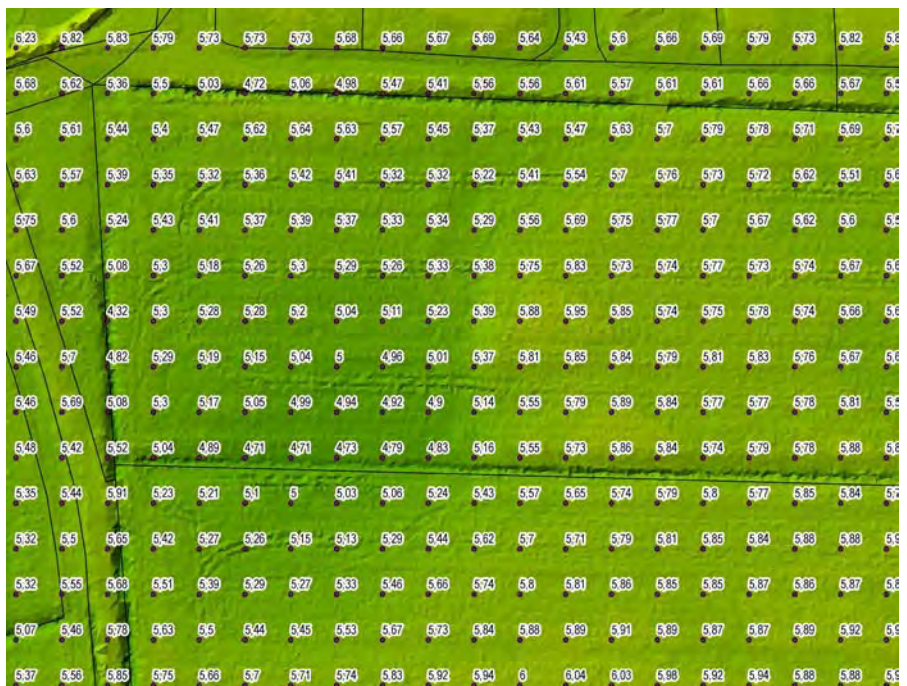
Abb. 14: Höhenraster zur Planung eines Regenrückhaltebeckens
